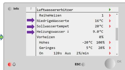
Der Fehler des Frostschutzthermostats kann mehrere Ursachen haben. Es kann das Problem beim Anlagenstart Slide 5, beim Stillstand der Anlage, Slide 6, oder es kann an der Wassertemperatur (wie hier beschrieben) liegen.
